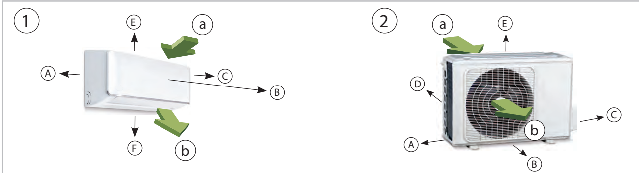
Abb. 24: Mindestfreiräume Innengerät und Außenteil
